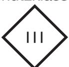
Der Schutz gegen elektrischen Schlag beruht auf Anwendung der Schutzkleinspannung (SELV).
