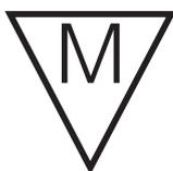
Leuchten mit diesem Zeichen eignen sich zum Anbau an oder Einbau in Möbel. Es handelt sich um Möbelleuchten für Entladungslampen mit eingebauten Vorschaltgeräten, geeignet zur Montage auf Flächen, deren Entzündungstemperatur mind. 200°C beträgt
