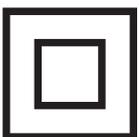
Spannungsführende Teile sind gegenüber berührbaren Metallteilen mit einer zusätzlichen Schutzisolierung versehen. Der Anschluss des Schutzleiters ist nicht erlaubt.
