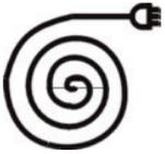
max. entnehmbare Leistung bei aufgewickelter Leitung
